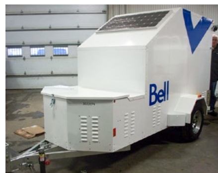
Remorque de Bell munie d'un panneau solaire de 80 watts qui permet de recharger une batterie de 12 volts.
