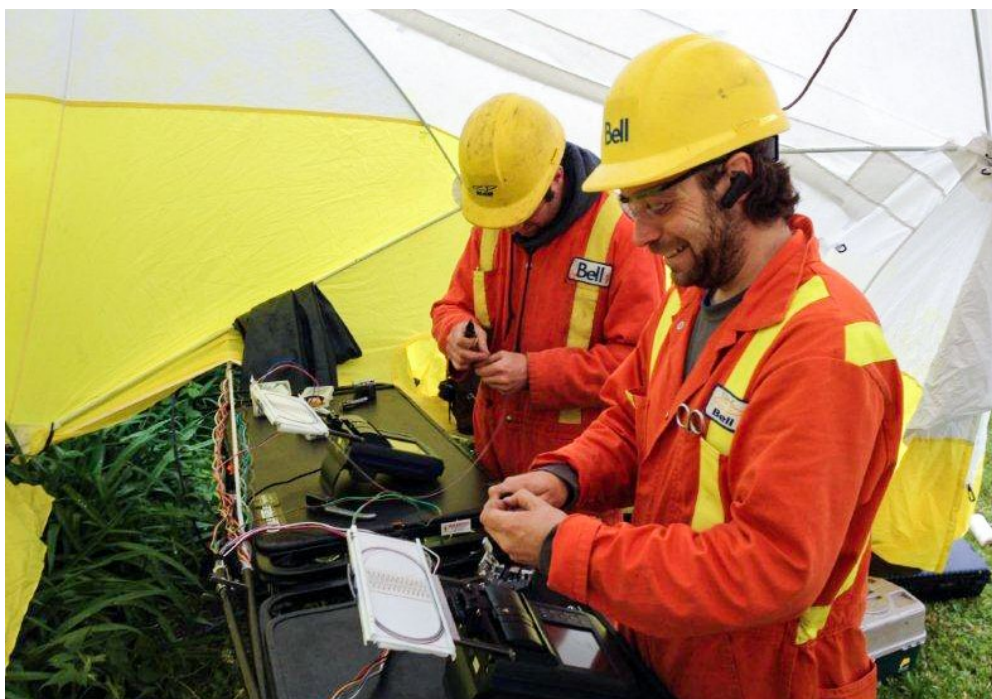
Des membres de l'équipe Bell mettent à l'essai un répulsif contre les écureuils pour protéger la gaine des câbles optiques.
